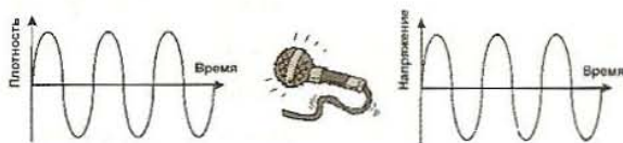
Рис. 3.4 Преобразование звуковых волн в электрический сигнал
